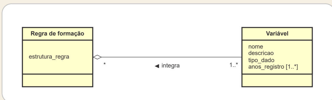
Figura 21 – Associação todo-parte por agregação “integra” entre as classes “Regra de formação” e “Variável”
